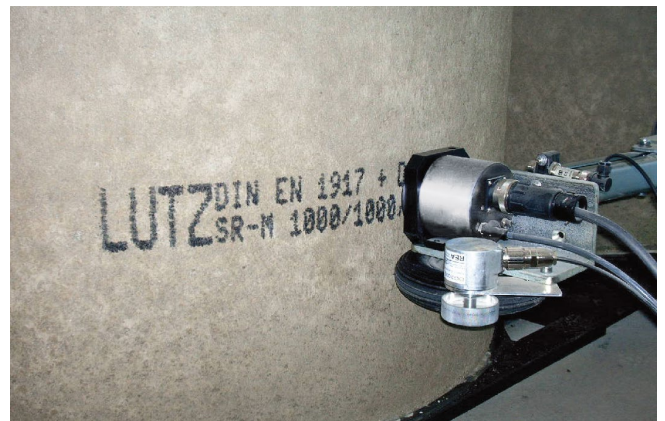
Beschriftung von Betonrohren
