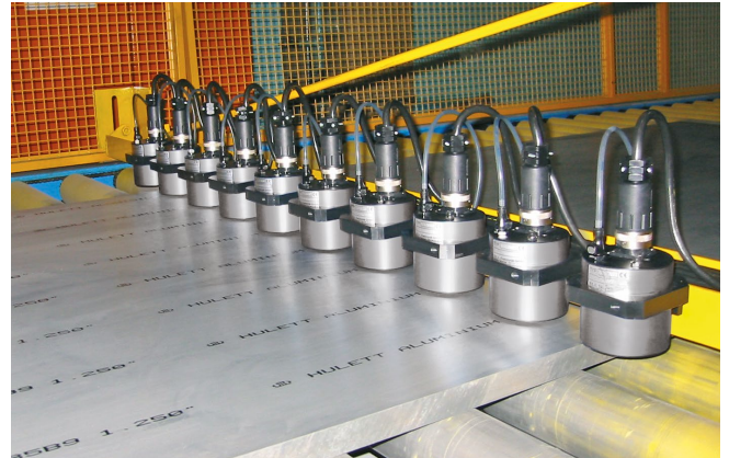
Beschriftung von Aluminiumplatten
