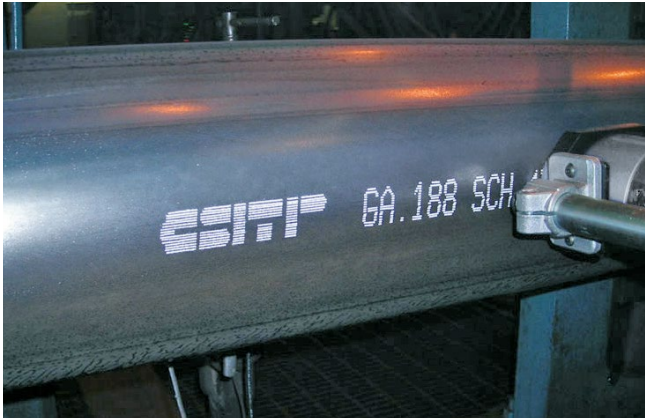
Kennzeichnung von Rohren (Stahl, Kunststoff etc.)
