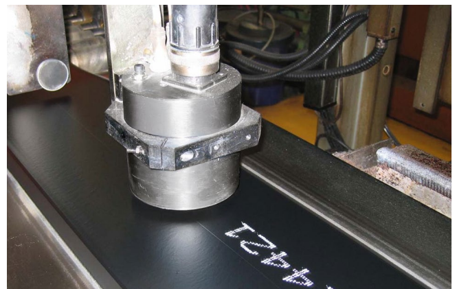
Laufstreifenkennzeichnung von Rohgummi
