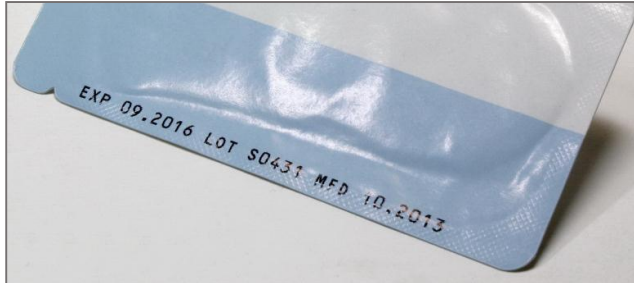
Beispiel Kennzeichnung auf Kunststoff-Folie einer 4-rand Siegelbeutelverpackung
