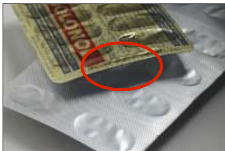
Beispiel auf einer Blisterverpackung, Aluminium Durchdrückfolie und/oder Kunststoff-Deckfolie
