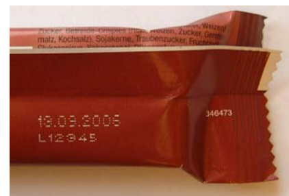
Laserbeschriftung sogar für Schlauchbeutel bis 400 Packungen / Min. (mit Punktmatrix)
