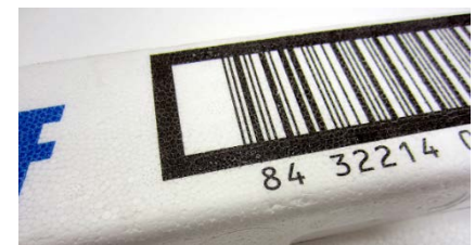
mit UV LED härtender Tinte auf Styropor
