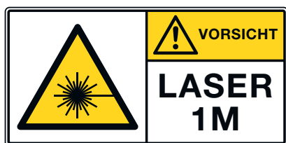
Bild 6: Kennzeichnung für Laser der Klasse 1M. Alternativ kann auch die Kennzeichnung, wie in Kapitel 6.2, verwendet werden.
