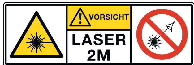
Bild 10: Kennzeichnung für Laser der Klasse 2M. Alternativ kann auch die Kennzeichnung wie in Kapitel 6.2 verwendet werden.
