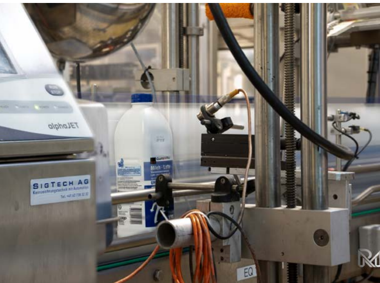
Inkjet-Drucker vom Typ AlphaJET into von Koenig & Bauer Coding GmbH in einer Abfülllinie.
