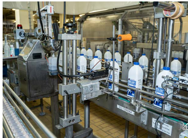
Einer von den 16 neuen AlphaJET-Druckern vollautomatisiert in die Abfülllinie integriert.
